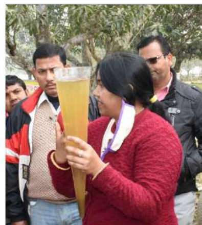
"इमहोफ कोन" प्लोक की मात्रा मापने का उपकरण
